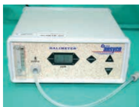
Abb. 1: HALIMETER zur quantitativen Messung schwefelhaltiger Verbindungen
